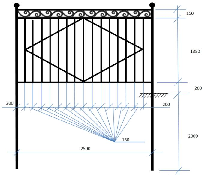
Ограждение общей длиной 70,5 погонных метров. Размер секций 2500x1500 мм. Ограждение состоит из следующих материалов: столбы – труба квадрат 80х80х3 мм., наполнение: продольная труба прямоугольник 40х25х2 мм., поперечная труба квадрат 20х20х2 мм., рисунок – квадрат 15х15х1 мм., окончания элементов рисунка развальцованны. Окончание столбов - квадрат с декоративным элементом – шар диаметром 80 мм.
