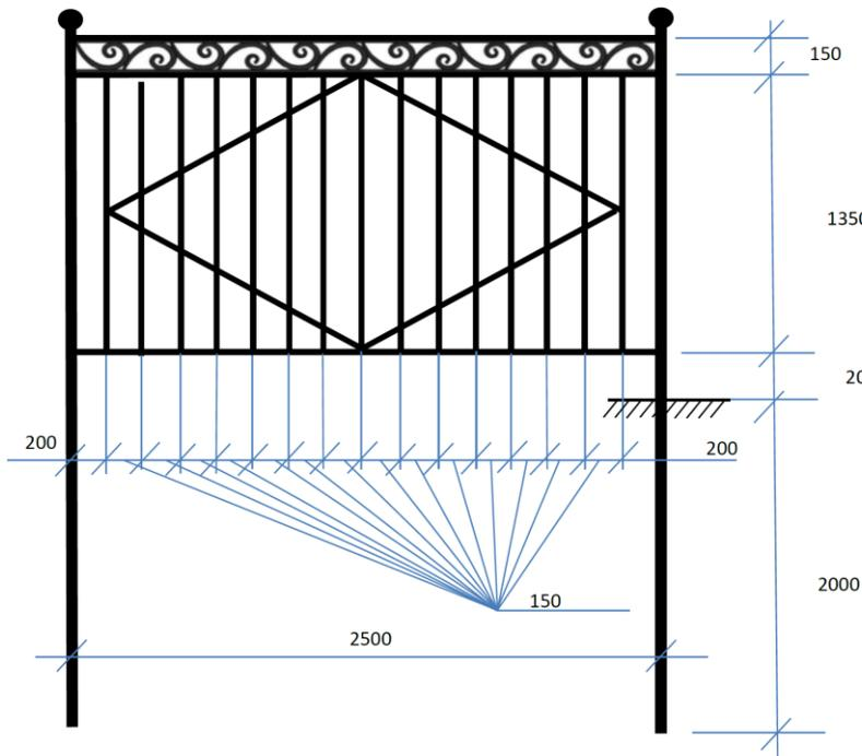
Ограждение общей длиной **56** погонных метров. Размер секций 2500x1500 мм. Ограждение состоит из следующих материалов: столбы – труба квадрат 80x80x3 мм., наполнение: продольная труба прямоугольник 40x25x2 мм., поперечная труба квадрат 20x20x2 мм., рисунок – квадрат 15x15x1 мм., окончания элементов рисунка развальцованы. Окончание столбов - квадрат с декоративным элементом – шар диаметром 80 мм. Нижняя часть столбов глушится металлической пластиной 100x100x4 мм.
