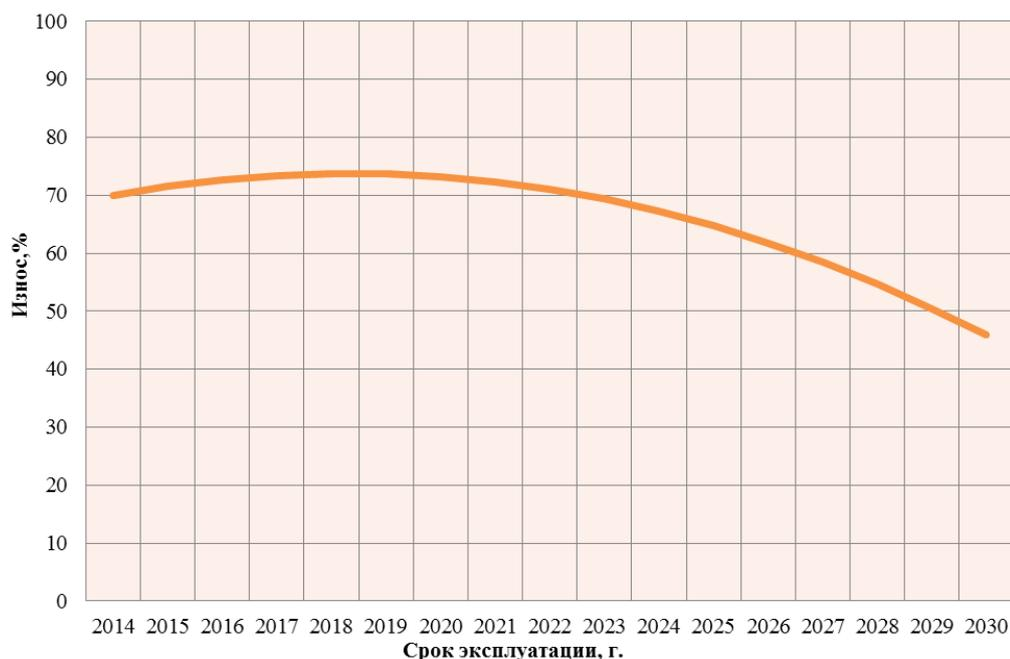
Рис. 7.2 - Зависимость износа тепловых сетей от срока эксплуатации
