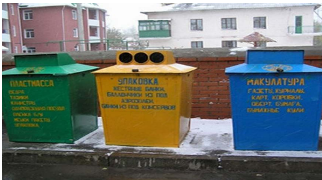
Рис. 4.6.1 – Контейнер К-0,75 с крышкой, доработанной для раздельного сбора отходов
