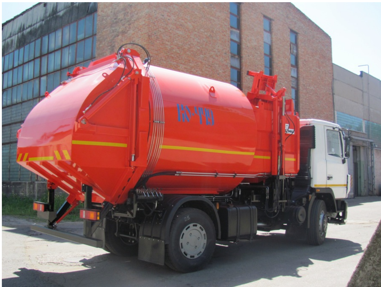
Рисунок 4.4 – Мусоровоз КО-449-33 на базе МАЗ-5340В2
