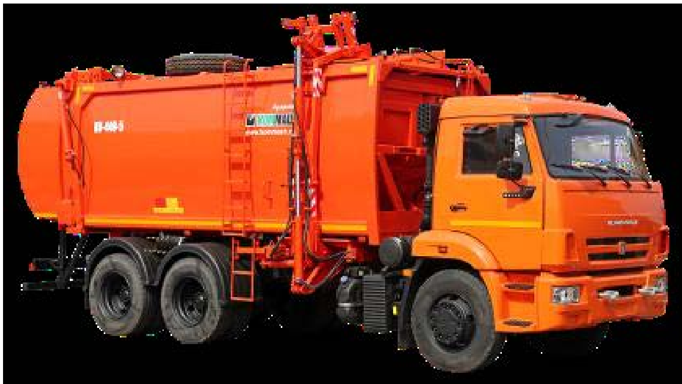
Рисунок 4.2 – Мусоровоз КО-440-5 на базе Камаз-65115
