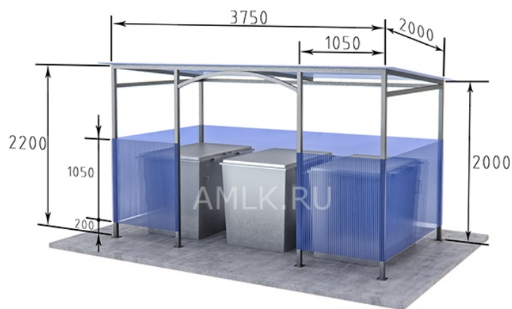
Рис.4.8.3 – Контейнерная площадка на 3 бака
